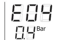
Quando si attiva il caricamento automatico dell'impianto sul display compare il simbolo
