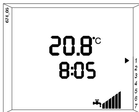
Durante questo funzionamento se viene aperto un rubinetto dell'acqua calda il bruciatore si accenderà automaticamente e sul display comparirà il simbolo .
