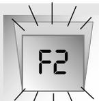
**>> Tentare un reset :** spostare l'interruttore per fermare la caldaia (apparirà **O**), attendere **5 s** poi riaccendere la caldaia (apparirà **I**).
