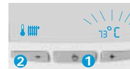
1- Premendo **2 volte** su
