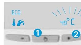
2- I tasti + e - vi permettono di variare la temperatura dell'acqua sanitaria da 38°C a 65°C in modo da ottenere la temperatura ottimale per le vostre esigenze.
