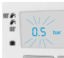
La caldaia si è fermata perchè ha rilevato mancanza d'acqua nell'impianto. E' necessario allora ripristinare la pressione aprendo l'apposito rubinetto blu posto sotto la caldaia fino a leggere la pressione di 1,2 bar sul display.
